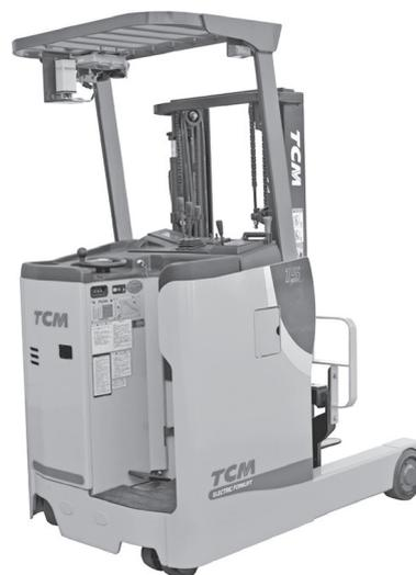
写真一 TCM パノラマ検知システム（フォークリフトに装着した状況）
