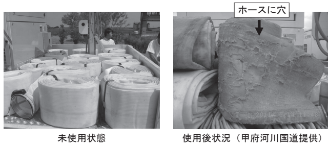
写真一六 機械の損耗
