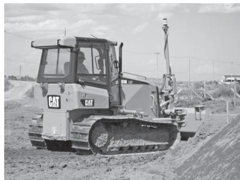
図-13 津波堆積物の剥ぎ取りに用いたブルドーザ (D3K)
