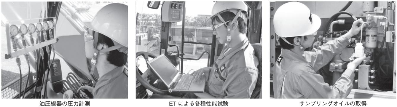
油圧機器の圧力計測
