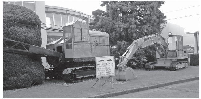
写真-6 機械式ショベルのU-05（左側）と機械遺産のUH03油圧ショベル
