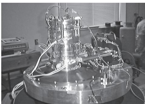
図-5 サンプル採取機構 (サンプリング部) 外観写真
