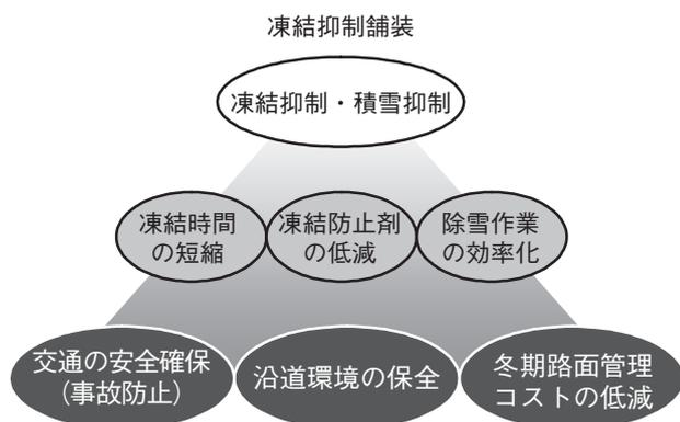
図—3 凍結抑制舗装の効果<sup>1)</sup>
