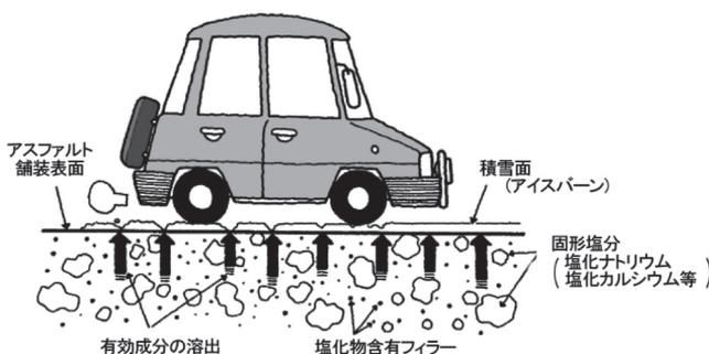
図—5 化学系凍結抑制舗装の原理<sup>1)</sup>
