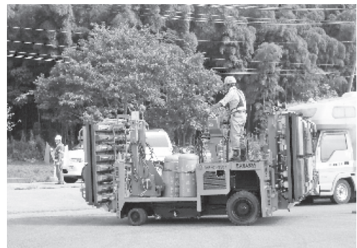
写真一 2 移動・運搬時の小型路面ヒータ車 (LPG 赤外線パネルを折り畳んだ状態)
