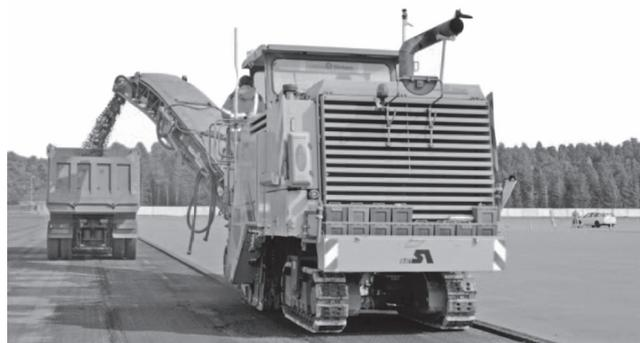
写真-1 作業に使用したクローラ式大型路面切削機（施工幅2.2 m）
