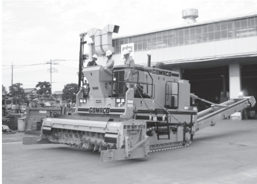
写真-1 地盤整正機全景
