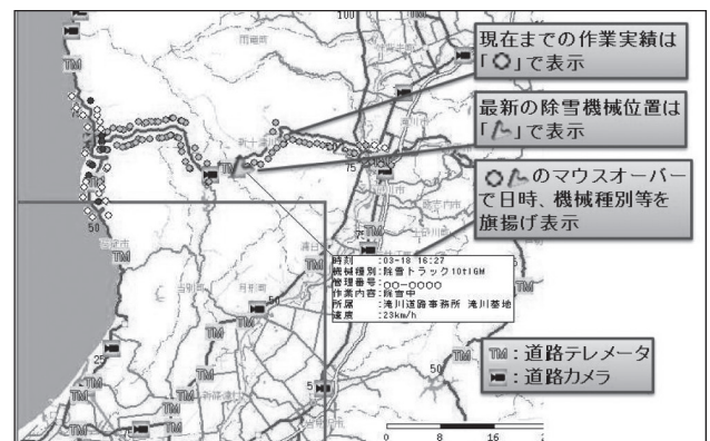
図一2 除雪作業状況確認システム表示画面
