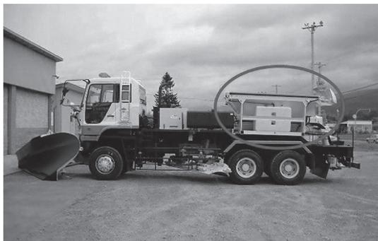
写真—19 凍結防止剤散布装置付除雪トラック
