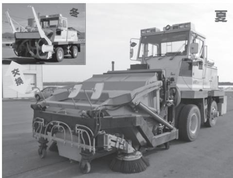
写真一23 アタッチメント式路面清掃装置
