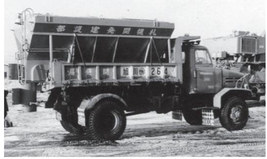
写真一15 凍結防止剤散布装置
