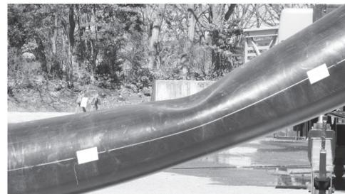
写真-4 高密度ポリエチレン管の変形状況
