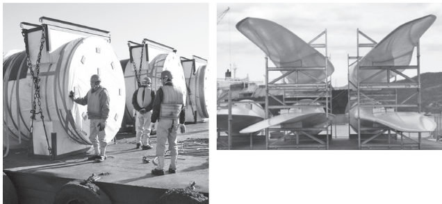
写真一六 実証機での輸送架台（左）と量産機での輸送架台（右）
