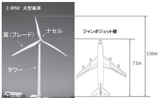
図-2 大型風車の構成
