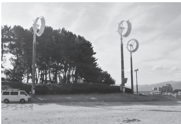
図一4 福岡市百道浜海浜公園に設置した5kW レンズ風車
