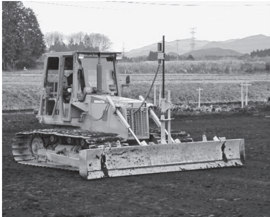
写真—3 ブルドーザの排土板制御システム
