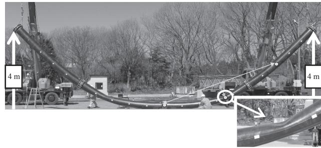
写真-3 高密度ポリエチレン管の曲げ試験状況
