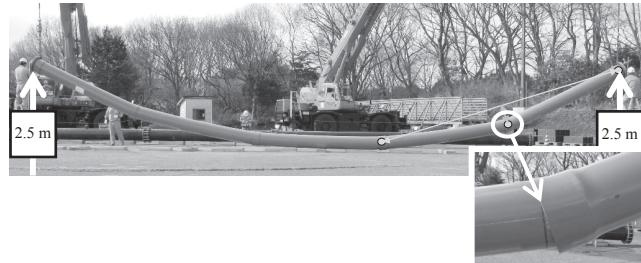
写真-4 硬質塩化ビニル管の曲げ試験状況
