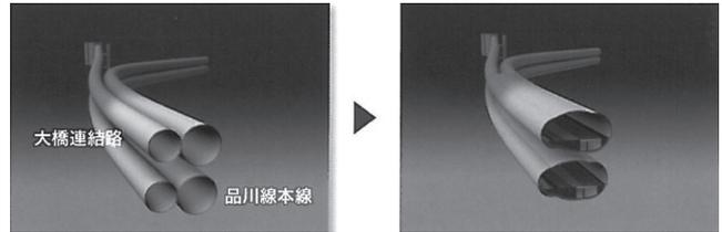
図-3 分合流部構築（工事パンフレットより抜粋）
