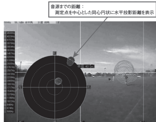
音カメラKYORImoによる測定結果：前方（約10m）と後方（約40m）より周波数の異なる音が発生している事がわかります。
