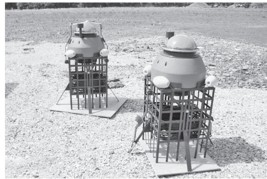
写真-11 投下型水位観測ブイによる水位の観測
