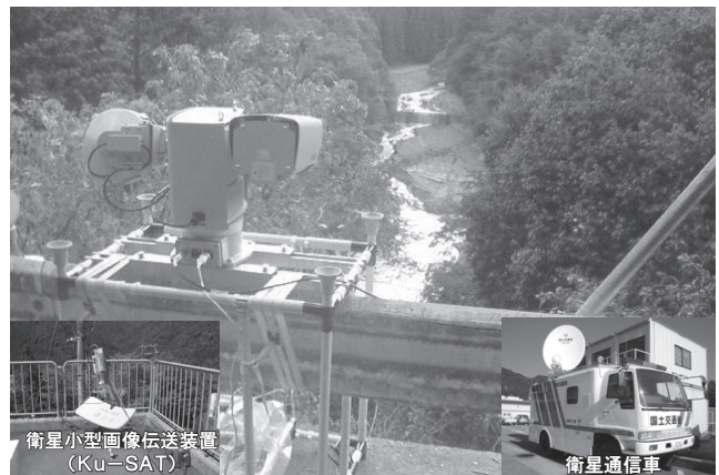
写真-13 固定カメラと衛星通信による24時間定点監視
