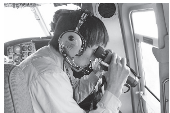
写真-9 上空からのレーザー測距計による計測
