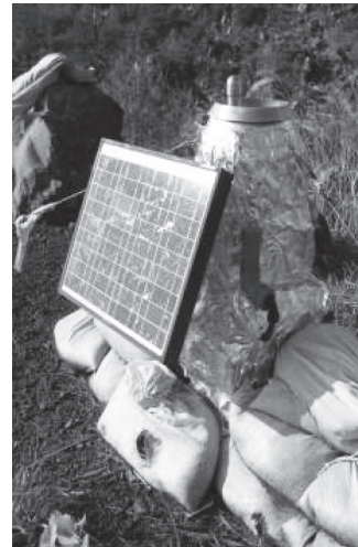
写真一 5 自動降灰量計による降灰量観測
