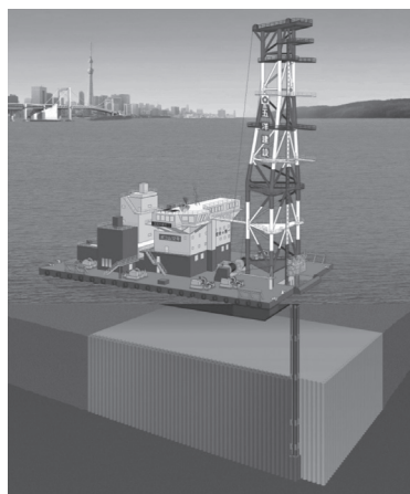
図—4 深層混合処理船 ポコム 12 号全景
