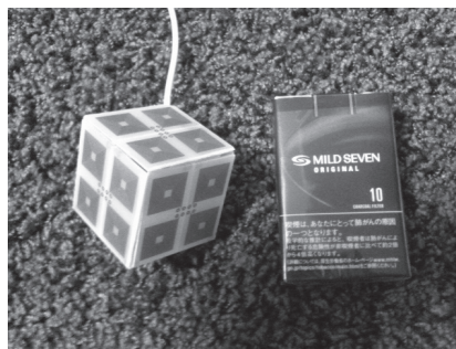
170-200 中心周波数 185 MHz 平均 24.5 dBi 図—6 Meta-Material 型 6 面送受信アンテナ
