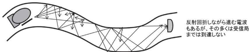
図-4 見通し外の電波伝搬のイメージ
