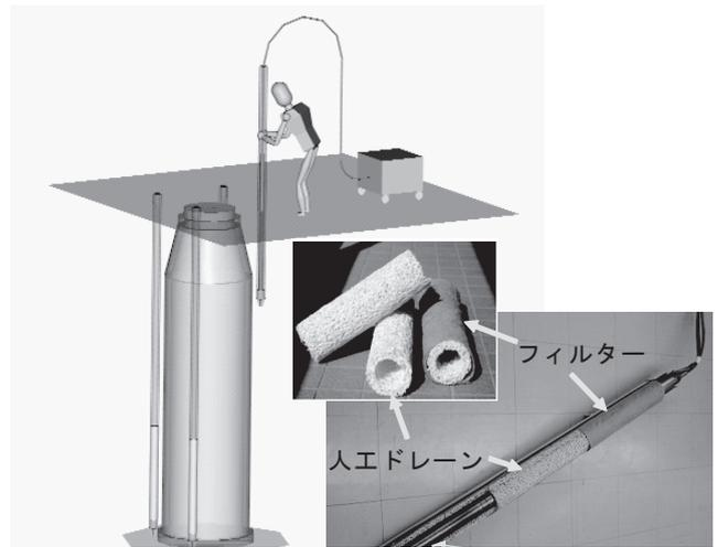
図-4 アースドレーン工法の装置概要
