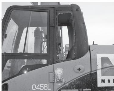
写真—6 重機燃料盗難によるガラスの破損
