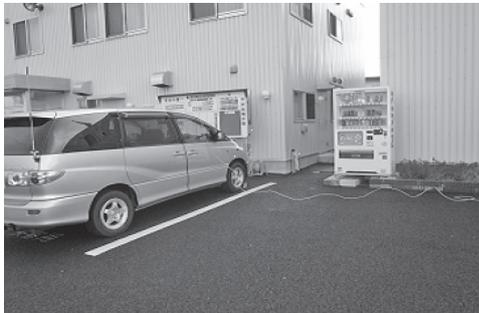
写真-3 ハイブリッド車にて電源確保
