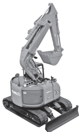
写真-1 コベルコ建機 SK130UR 油圧ショベル
