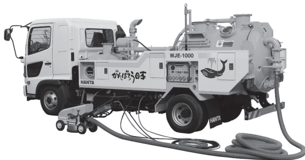
写真一 9 範多機械 WJE-1000 オールインワンタイプ万能表面処理車（ウォーターイレーサ）
