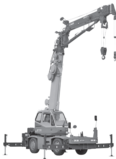
写真一6 タダノ GR-120F ラフテレーンクレーン
