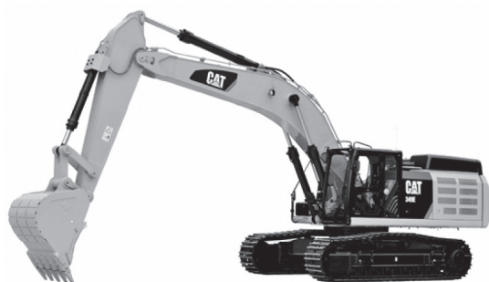
写真-2 キャタピラージャパン Cat 349E 油圧ショベル
