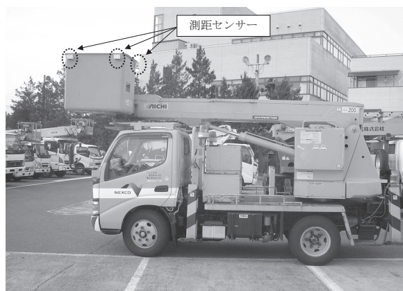
図一6 高所作業車への搭載状況
