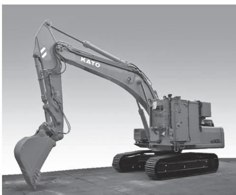
写真一 9 放射線遮蔽キャビン付き油圧ショベル (30t級, バケツ容量 1.4 m<sup>3</sup>)
