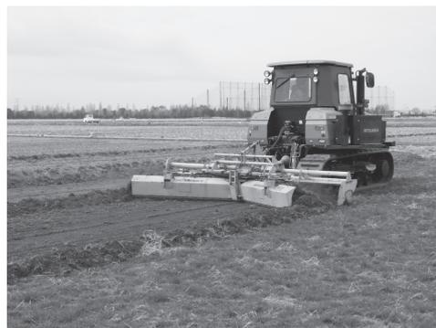
写真一 10 放射線遮蔽キャビン付きトラクタによる土壌除染 (表土の剥ぎ取り)
