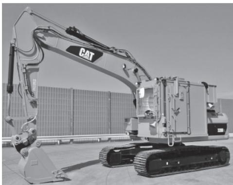
写真一 8 放射線遮蔽キャビン付き油圧ショベル (20t級, バケツ容量 0.9 m<sup>3</sup>)
