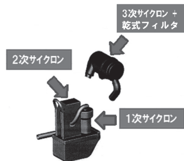
写真一6 3ステージサイクロン集塵装置
