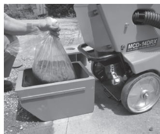
写真一5 切削粉回収用ポリ袋
