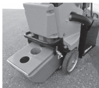
写真一4 ワンタッチ引き出し式大型 20ℓ ダストケース
