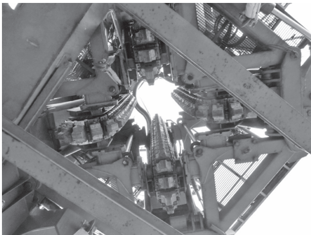
図一7 パイプ敷設装置のテンショナー部分 (渡邊撮影)
