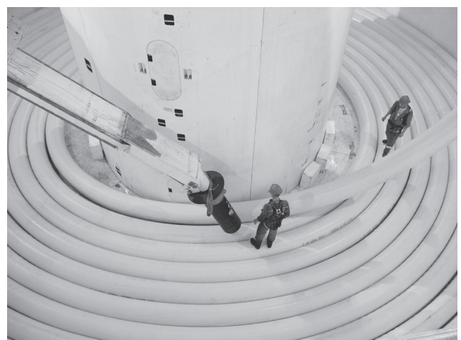
図-5 カールセルに巻かれたパイプライン (Courtesy of Acergy)
