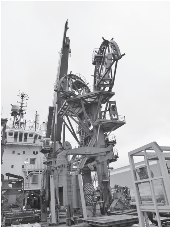
図一6 Acergy Eagle のパイプライン敷設装置 (渡邊撮影)
