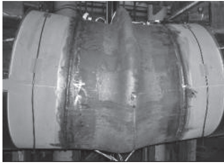
図一七 曲げ試験状況 (内面接触角度)
