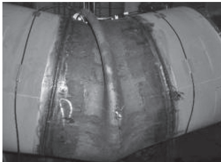
図一八 曲げ試験状況 (ストローク最大)
