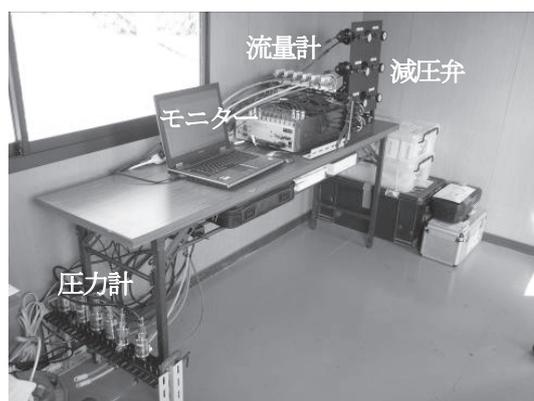
写真-1 空気注入システム
