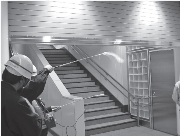
写真—4 ホーム排煙時の階段部下降気流の測定
