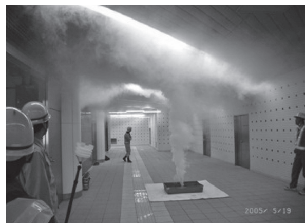
写真—3 コンコースでの発煙試験
