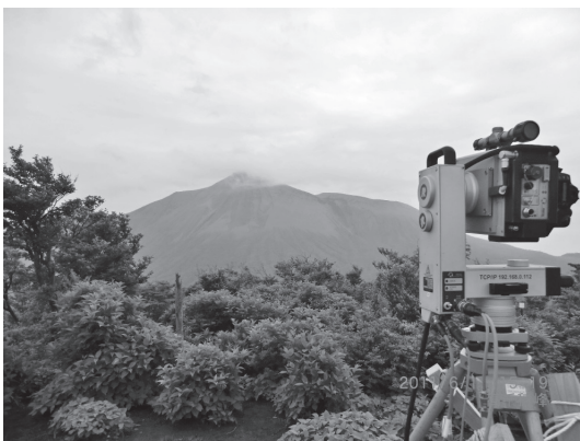
写真—5 地上レーザ計測の様子
