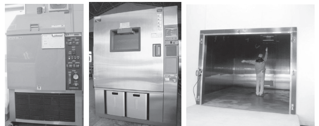
①湿潤試験機 ②環境負荷試験機 ③大型低温恒温室
