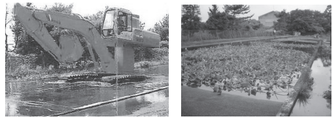
①水陸両用タワーショベル ②水生植物の回収実験
