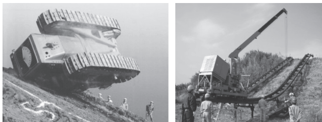
①ブルドーザの転倒実験 ②急傾斜での機械性能試験
