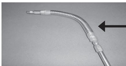
写真—5 ノズル先端部
