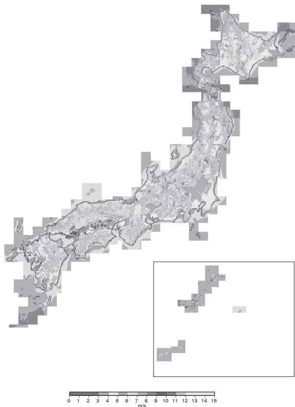
図一2 洋上風力発電のポテンシャルと有望海域（局所風況マップ 3) より作成。推計条件を年平均風速7m/s以上、水深0-200m、離岸距離を30kmまでとした）
