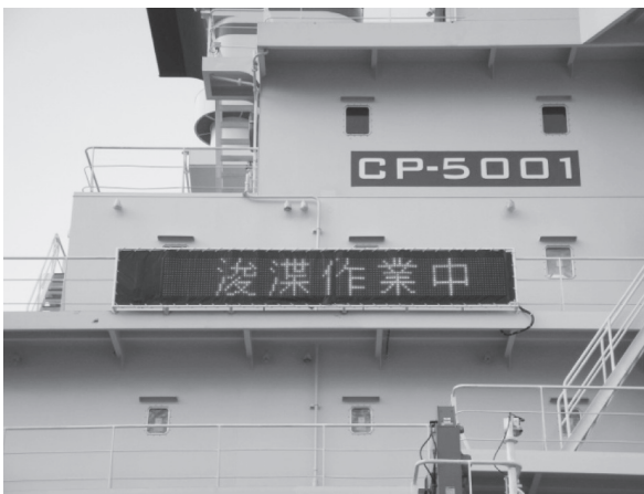
写真一九 電光掲示板システム
