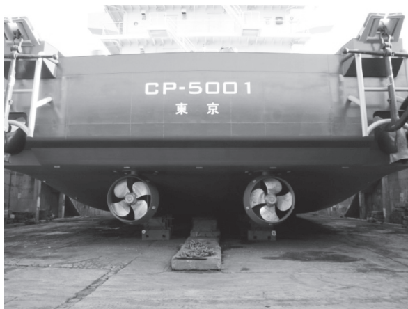
写真一2 推進機（全旋回式可変ピッチプロペラ）
