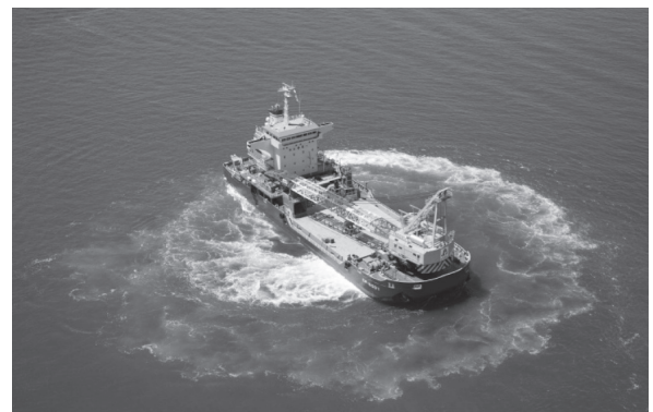
写真一5 定点旋回状況
