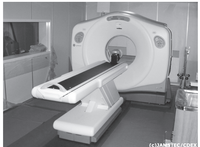
写真—3 「ちきゅう」研究室内に設置されているX線CTスキャナー 医療用に使用されている物を応用し、掘削した試料の非破壊検査に用いている。
