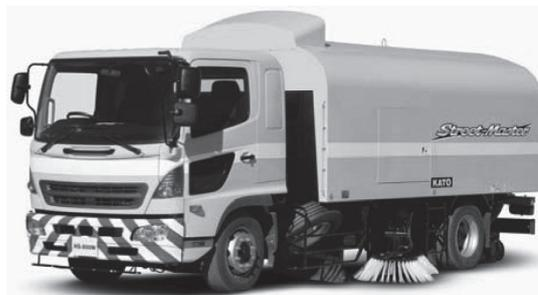
写真—4 加藤製作所 HS-800W 型 真空式路面清掃車
