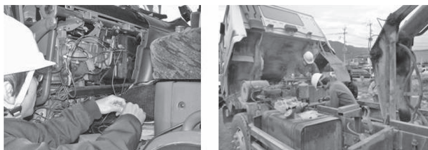
写真-2 デジタコ等配線を必要とする装置の取り付け作業の例
