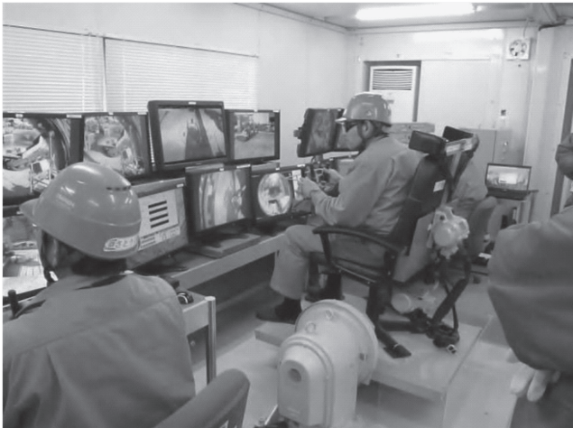
図一七 操作室における遠隔操作の状況
