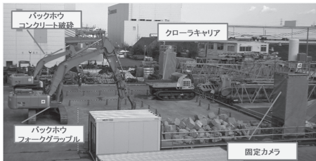
図-3 実験概要（実験に使用した機械と配置）
