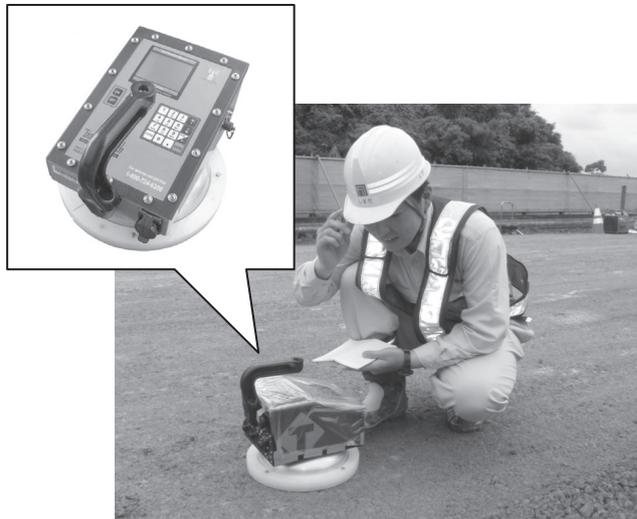
図—15 路盤密度測定機による計測状況
