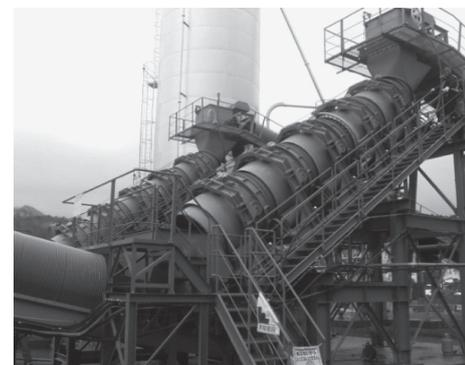
写真一 1 混合筒 5 連方式の SP ミキサ
