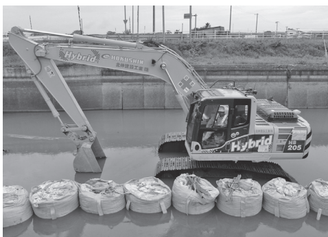
写真一五 ハイブリッド型バックホウの使用状況
