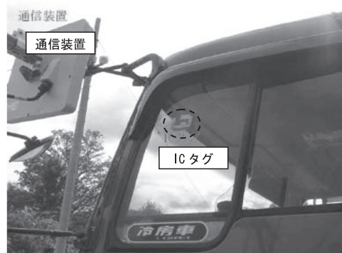
写真-2 骨材運搬管理システムによる情報伝達の状況
