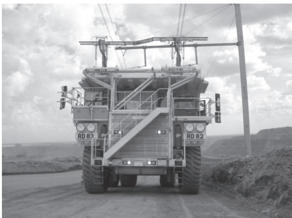
図-5 トロリー式ダンプトラックの外観
