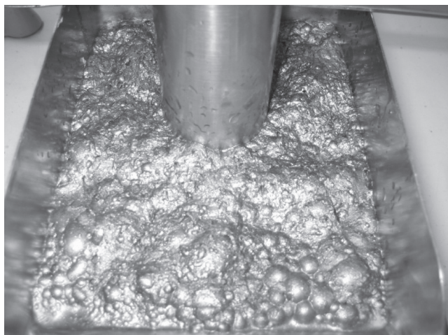
写真-1 フローテーション試験の状況
