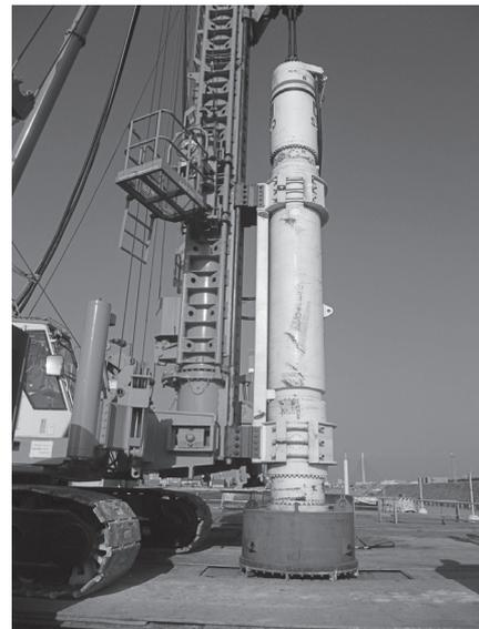
写真一五 装置なしの油圧ハンマ（本牧地区）
