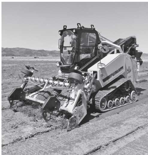
写真一 2 サナース販売（ドップシュタット製造）PUMA2400 表土剥離・回収機（作業時）
