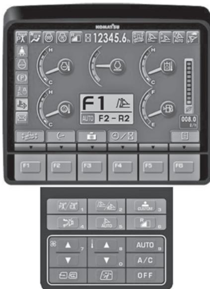
図-9 高精細7インチLCDモニター
